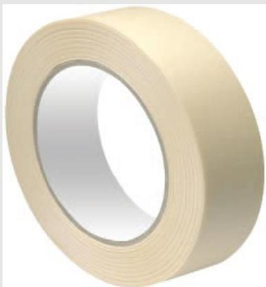
Малярная лента бумажная общего назначения со средней адгезией. Термостойкость до 80°C. УФ стойкость до 3 дней. Высококачественный акриловый клей на водной основе. Для гладких поверхностей внутри помещений. Для четких и ровных границ при окрашивании.
