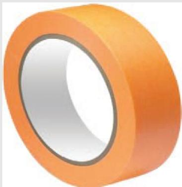
Малярная лента из **тонкой рисовой бумаги, для гладких поверхностей**, высокая адгезия. Термостойкость до 120°C. УФ стойкость до 30 дней. Высококачественный акриловый клей на водной основе. Для использования на гладких, проблемных поверхностях, таких как: **стекло, пластик, алюминий, твердый ПВХ**, Для четких и ровных границ при окрашивании
