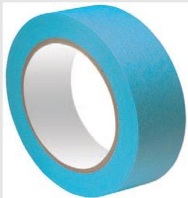
Малярная лента бумажная, тонкая, **для деликатных поверхностей**, низкая адгезия. Термостойкость **до 120°C**. УФ стойкость до **30 дней**. Высококачественный акриловый клей на водной основе. Предназначена для деликатных поверхностей, таких как: **обои, поверхности, покрытые лаком, свежеекрашенные поверхности** и т.п. Для четких и ровных границ при окрашивании.
